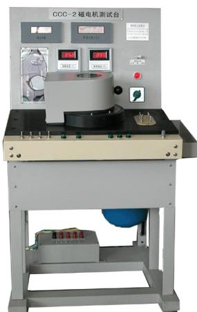
CCC-2 磁电机测试台采用进口变频器驱动变频电机，具有转矩平稳、转速稳定、调速方便、电机免维护等特点。各测量通道均采用真有效值（AC+DC）测量（峰值电压除外），保证测量结果不受信号失真的影响。可为用户定制无感电阻负载，并提供负载盒，使用户对负载可采用油冷措施，保证了负载的散热。设备提供两组三针放电器和放电盘一个，既可直观反映点火角的变化，亦可通过一组三针放电器检查磁电机在全速范围内有无断火，各通道测试点均引入到专用接线端子，可随意改变负载接法。
